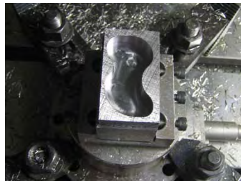
図5 提案した工具経路生成法を用いた加工試験
