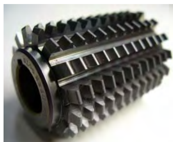
図4 切削工具ホブとその損傷
