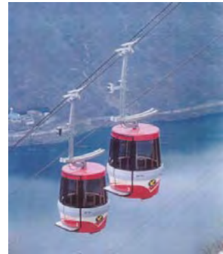
図4 屋根に動吸振器をつけたゴンドラ
