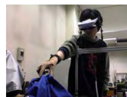
図 5: 多指遭遇型ハプティックデバイスによる物体把持のシミュレーション
