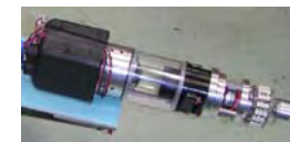
図 11: 瓦礫内3次元マップ生成のためのレーザーレンジファインダ
