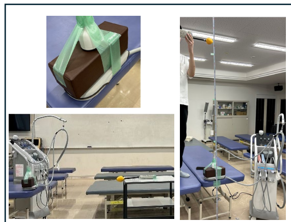
図 2 超短波治療器での測定
