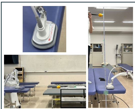
図 1 極超短波治療器での測定
